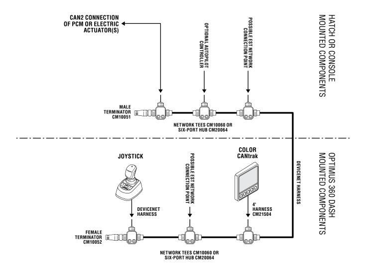
Figure 3-2. Generic CAN2 wiring diagram.
