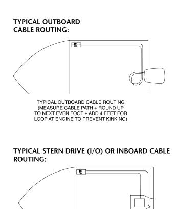
TYPICAL STERN DRIVE/INBOARD CONTROL CABLE ROUTING (MEASURE CABLE PATH + ROUND UP TO NEXT EVEN FOOT)
